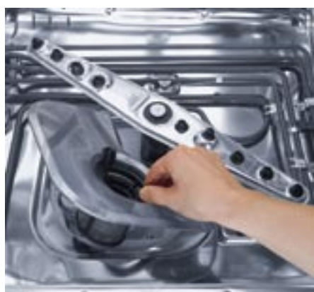
Система фильтрации в моечной камере
