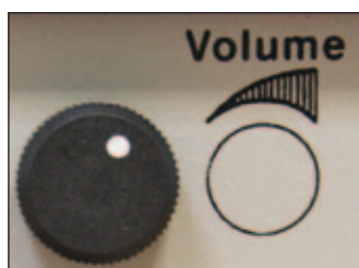
Рис. 37. Регулятор уровня громкости звукового сигнала «Volume»
