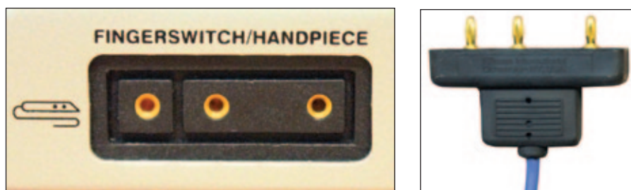
Рис. 23. Гнездо для подключения монополярного наконечника-держателя (слева). Штекер монополярного наконечника-держателя (справа)
