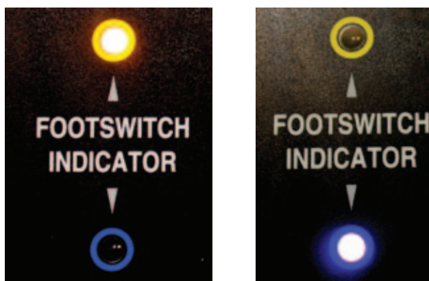
Рис. 24. Активирована ножная педаль режимов разреза «Cutting Mode» (слева). Активирована ножная педаль режимов коагуляции «Coagulation Mode» (справа)
