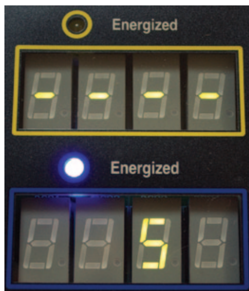
Рис. 32. Индикатор (синий) активации режимов разреза коагуляции «Coagulation Mode» «Energized» (Под напряжением). Цифровой дисплей значений мощности для режимов коагуляции «Coagulation Mode» (Внизу)
