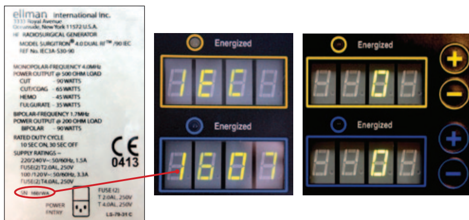
Рис. 18. Последовательность отображения значений на цифровых дисплеях при включении: слева и в центре – серийный номер аппарата (соответствие номеру на задней панели), справа – значения мощности в исходной позиции: на обоих дисплеях отображается «ноль».
