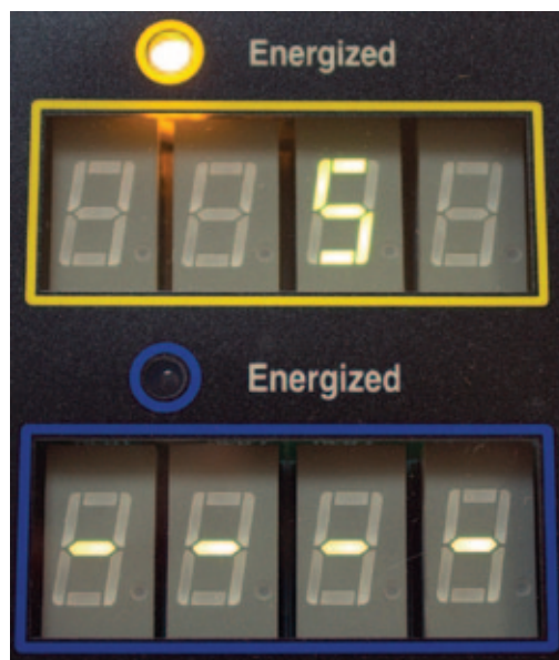
Рис. 31. Индикатор (желтый) активации режимов разреза «Cutting Mode» «Energized» (Под напряжением). Цифровой дисплей значений мощности для режимов разреза «Cutting Mode» (Вверху)
