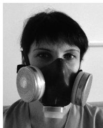
Рисунок 7. Фильтрующий противогазовый респиратор РПГ-67
