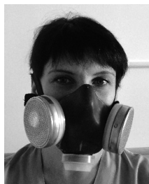
Рисунок 7. Фильтрующий противогазовый респиратор РПГ-67
